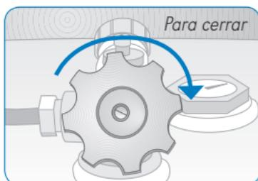
**Válvula de gas del tanque**
